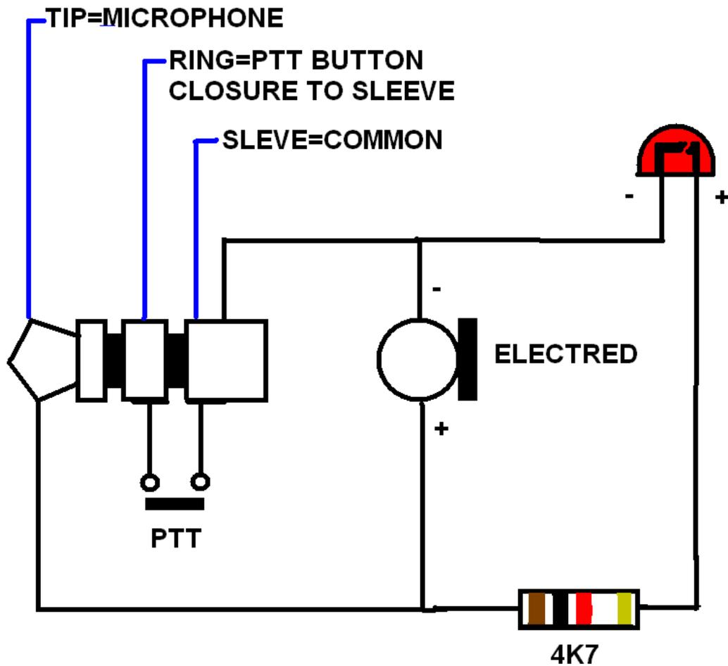
I collegamenti dei del pin microfono sono i seguenti . Il connettore del microfono è uno spinotto stereo standard di Ø 3.5 mm.
